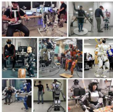
Рисунок 1. Примеры дистанционного управления роботами-гуманоидами.
