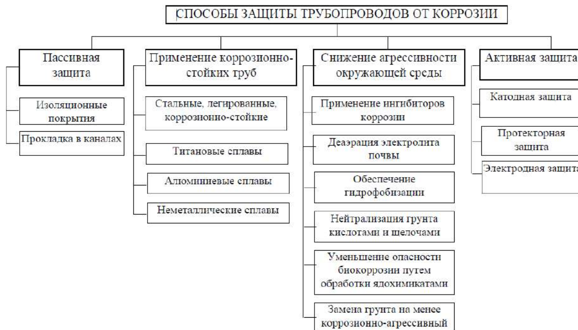
Рис.1 – Классификация способов защиты трубопроводов от коррозии
